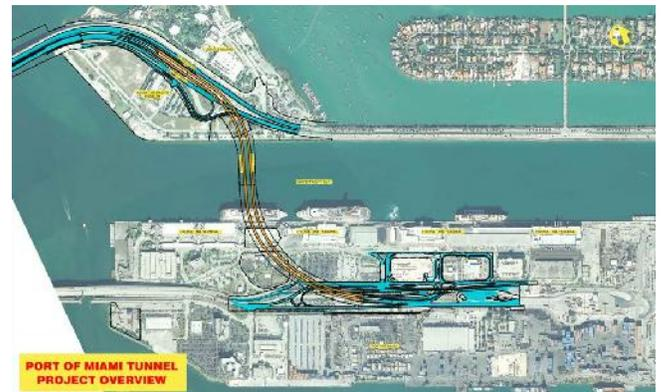
Los dos túneles de una altura máxima de 11,8 m y 1,2 km de longitud cada uno, albergando dos carriles para el tráfico rodado en cada sentido. Las tareas de construcción se dividieron en diferentes partes, como los trabajos de la calzada de Watson Island, la ampliación del MacArthur Causeway Bridge, la perforación del primer túnel de Watson Island
